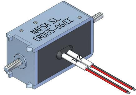
重要提示: 固定螺钉需要超出电磁铁外壳会导致损坏线圈
